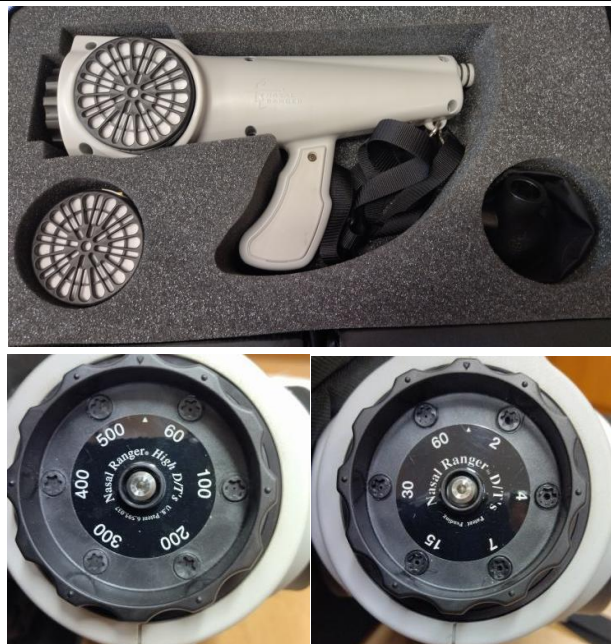
Rysunek 2. Olfaktometr terenowy Nasal Ranger firmy St. Croix Sensory, Inc. (góra) oraz tarcze do rozcieńczeń (dół) do uzyskania niższych (zdjęcie po lewej stronie) oraz wyższych rozcieńczeń (zdjęcie po prawej stronie) próbek zapachowych [opracowanie własne]
